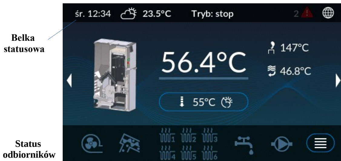
Ilustracja 7: Ekran główny, ekran kotła C.O.
